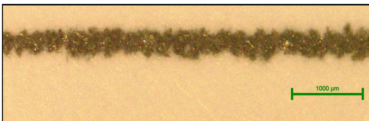
Obr. 1.: Fotopapír, 5mms -1 , 200V, 20Hz, 50μm, butanol.
